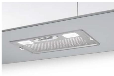
Installazione gruppo incasso • Aspirante • n.1 motore • Regolazione motore a 3 velocità con Slider • Pressione 240 Pa • Rumorosità massima 62 dB • Rumorosità minima 48 dB • Assorbimento totale 230W • Illuminazione con 2 lampade ad incandescenza da 40W • Filtro grassi sintetico + filtro carbone
